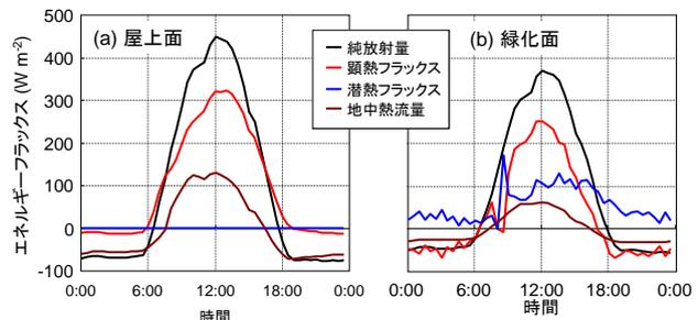
図2. 屋上面と緑化面における平均的なエネルギーフラックスの日変化
