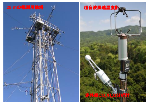
写真 1 ヒノキ林の観測用鉄塔と渦相関法測定システム
