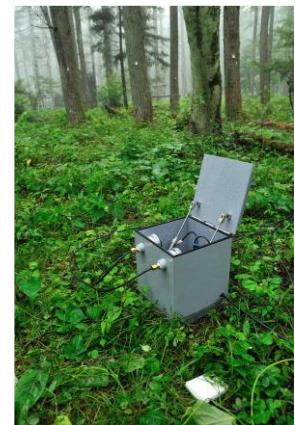
図1 森林土壌に取り付けられた土壌呼吸測定用チャンバー
